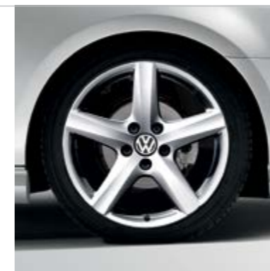
Volkswagen Individual Volkswagen Exclusive Легкосплавный диск Avignon Диск: 7J x 17", ET 54, LK 112/5 Шина: 225/45 R17 Цвет: серебристый Sterling Арт. 1K0071497AE 88Z
