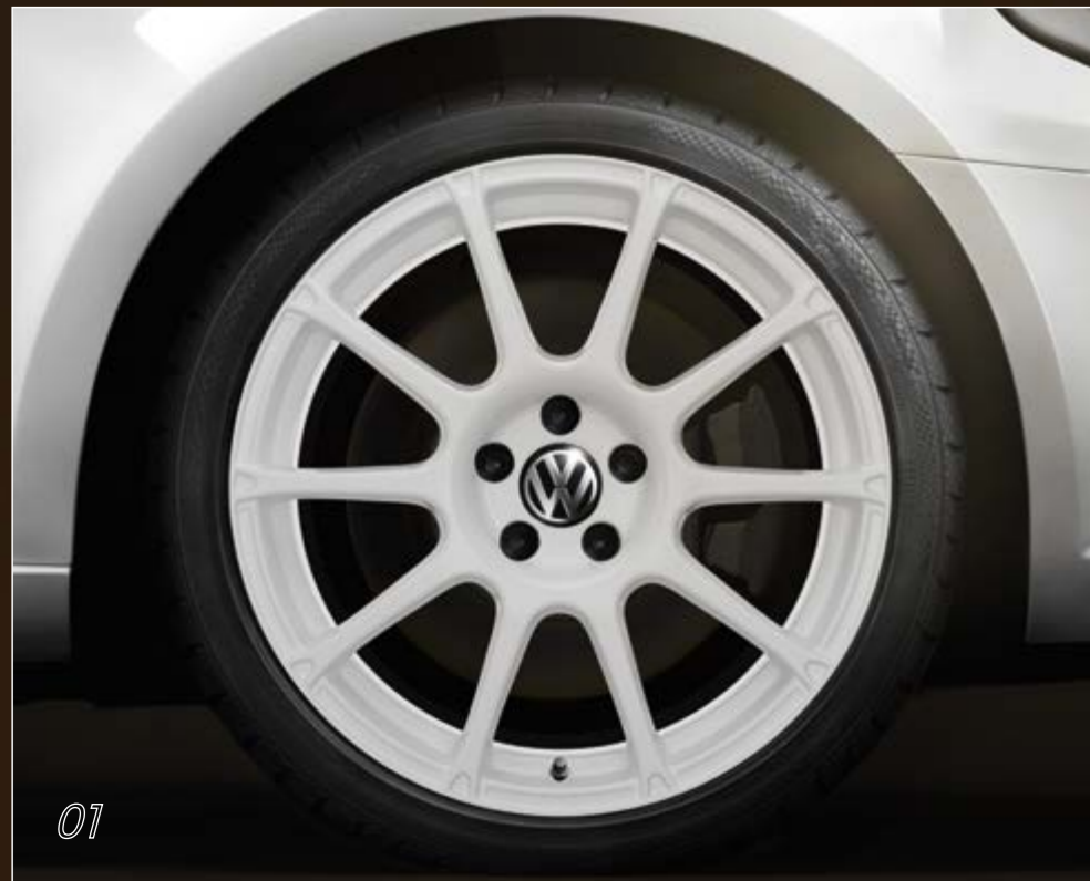
01 Volkswagen Original Легкосплавный диск Motorsport Цвет: белый, размер диска: 8J x 19", ET 41, LK 112/5, допустимый размер шин 1 : 235/35 R19 Арт. 1K8 071 499 A Y9C
